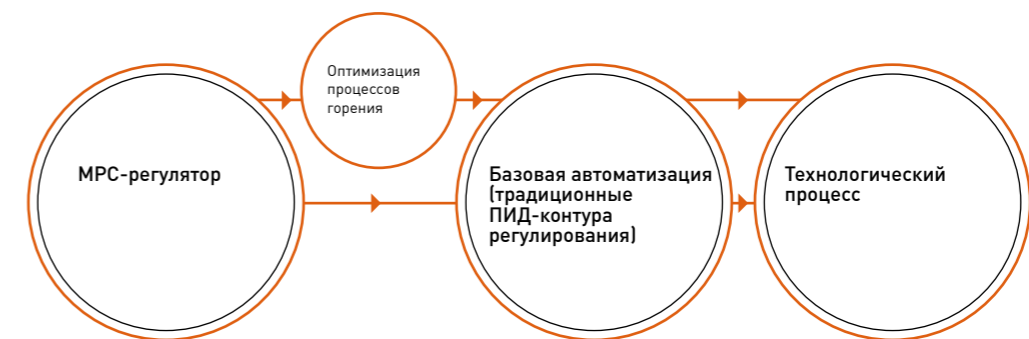
Типовая структура системы автоматизации энергоблока, основанная на модельном прогнозирующем управлении
