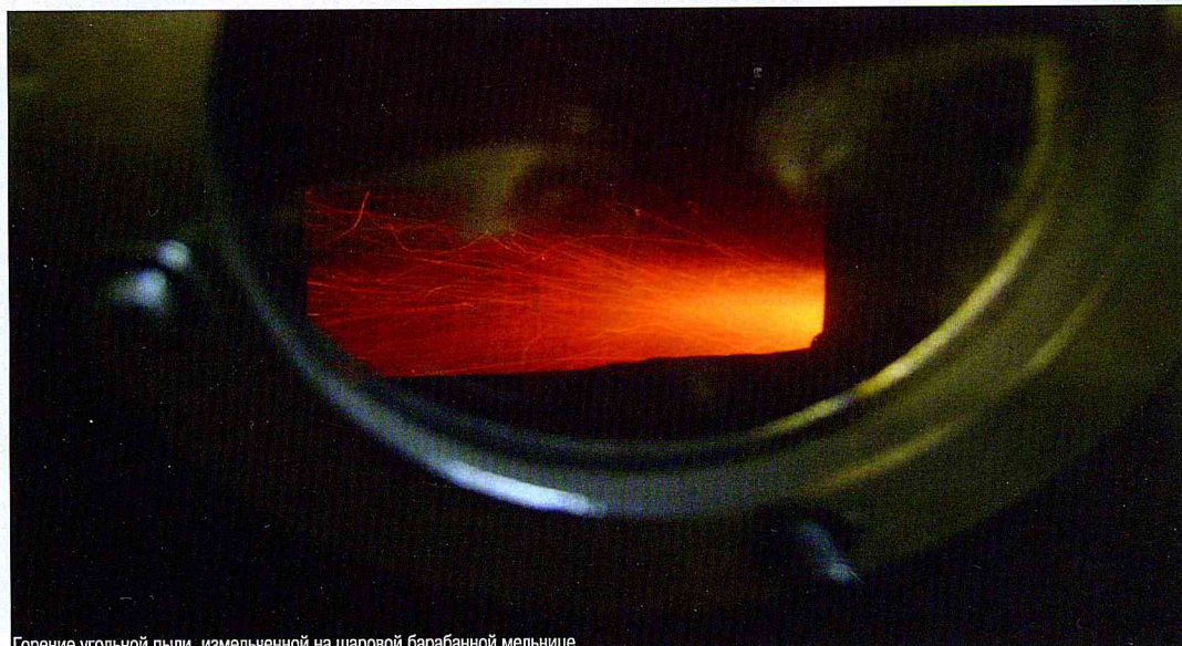
Горение угольной пыли, измельченной на шаровой барабанной мельнице
